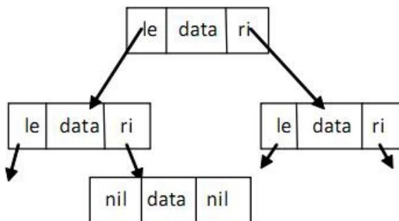
二叉树中每个节点最多能链接至两个节点：左节点 (`le`) 和右节点 (`ri`)，这两个节点本身又可以有左右节点，依次类推。树的顶层节点叫根节点 (`root`)，底层没有子节点的节点叫叶子节点 (`leaves`)，叶子节点的 `le` 和 `ri` 指针为 `nil` 值。在 Go 中可以如下定义二叉树：
